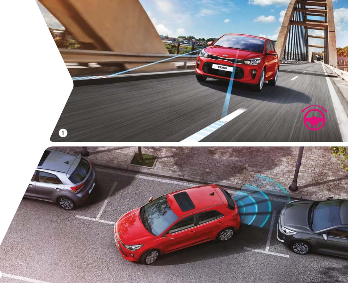
**1. Asistent udržania jazdného prahu (LKA)** Asistent udržania jazdného prahu (LKA) vás upozorní, keď neúmyselne vybočíte z vášho jazdného prahu a dokonca vás v prípade potreby nasmeruje späť.
