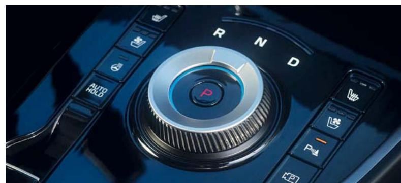
**Elektronický volič prevodovky (Shift-by-wire).** Elektronický otočný volič je umiestnený v strede a na dosah ruky a funguje pomocou technológie elektronického radenia, ktorá umožňuje presné a okamžité radenie. Vďaka tlačidlu výberu jazdného režimu na volante môžeš rýchlo vykonávať zmeny. Automaticky zaradí prevodový stupeň P (parkovanie), ak na to vodič zabudne, čo je dôležité z hľadiska bezpečnosti.
